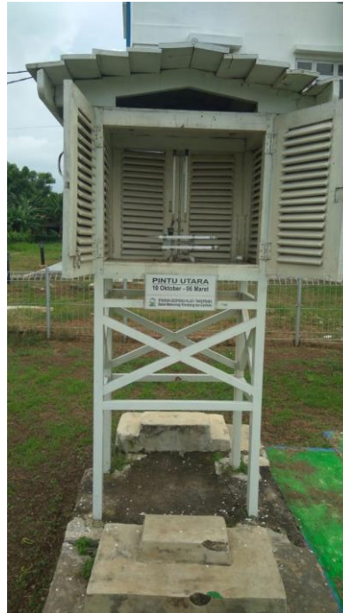
Gambar 3. Sangkar Meteorologi
